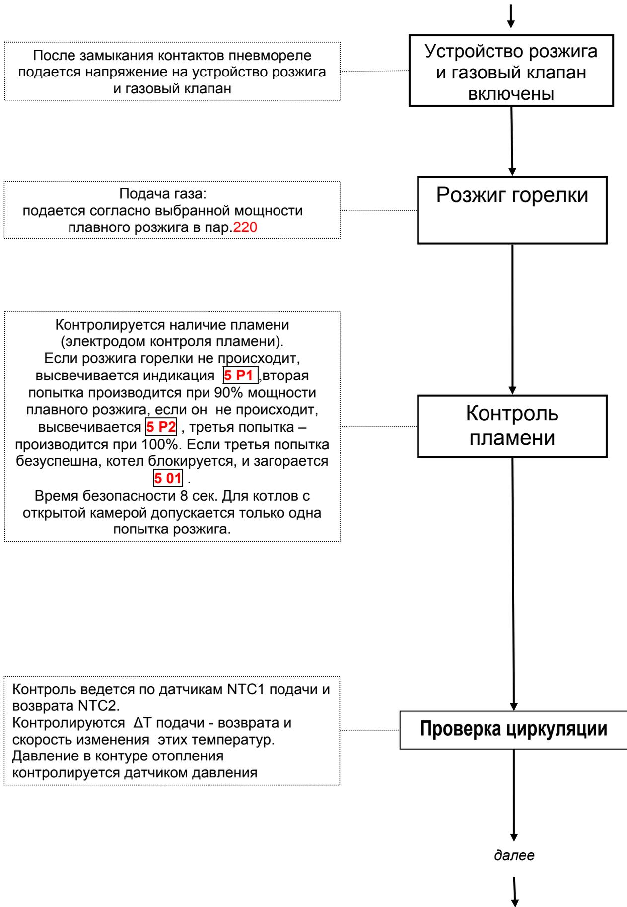
Модуляция происходит между максимальной мощностью ГВС (устанавливается на газовом клапане) и минимальной мощностью (так же устанавливается на газовом клапане). Горелка выключится при достижении температуры защиты от накипи (контролируется датчиком NTC2).
